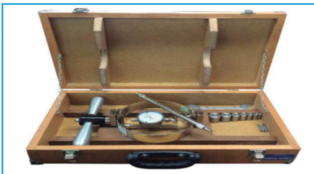
Figura 2. Penetrômetro de solos com anel dinamométrico.
