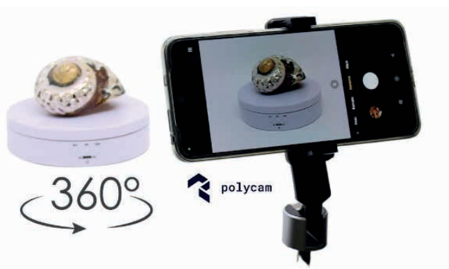
Figura 1. Sistema de estúdio portátil utilizado para o escaneamento 3D, com um exemplar de concha do molusco Turbo sarmaticus (Trochida: Turbinidae).
