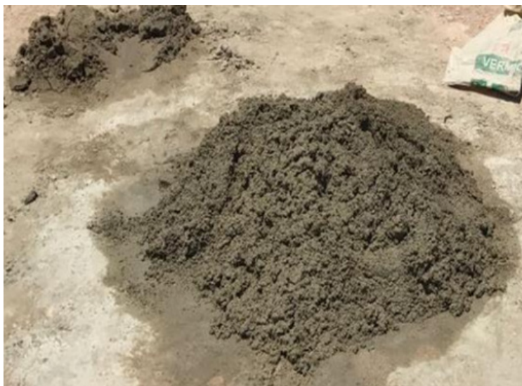
Figura 5. Foto de mistura do traço cimento e vermiculita
